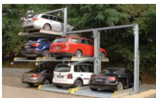
Înainte de coborârea platformei superioare, trebuie scos autoturismul aflat pe platforma inferioară
