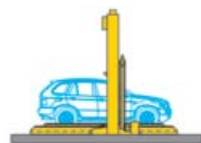
Înainte de coborârea platformei superioare, trebuie scos autoturismul aflat pe platforma inferioară
