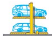
Autoturismul aflat la nivelul de intrare trebuie scos înainte de coborârea platformelor
